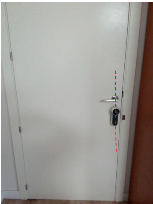
Figura 12 Montaje sobremesa con orientación incorrecta.
