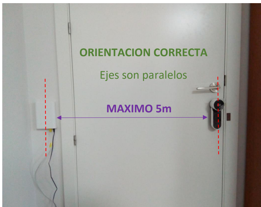
Figura 9. Montaje en pared con orientación correcta.
