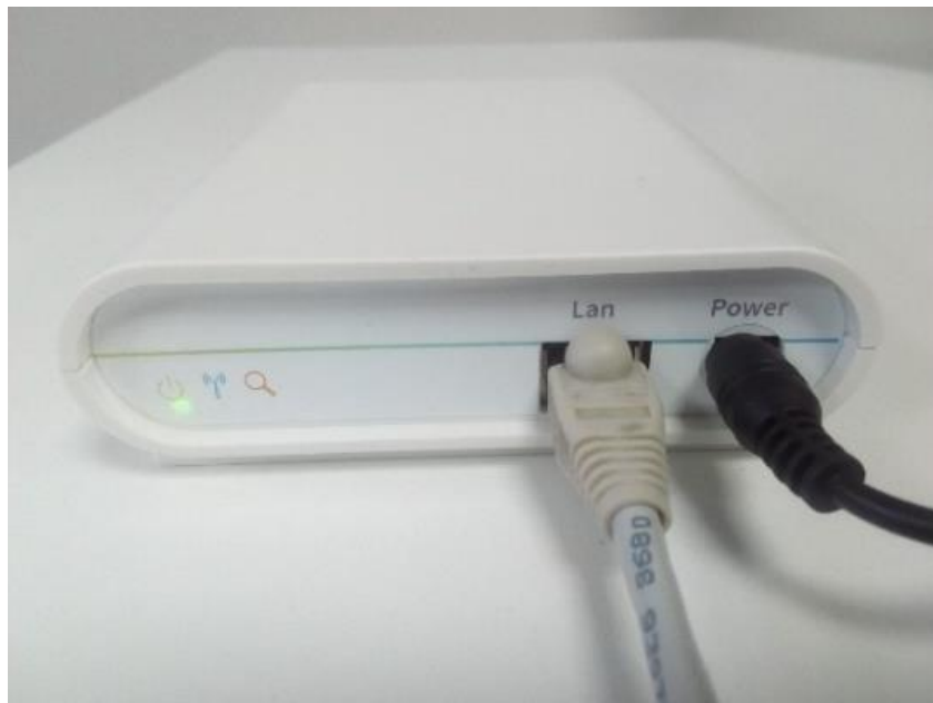
Figura 8 Conexión de pasarela domótica.
